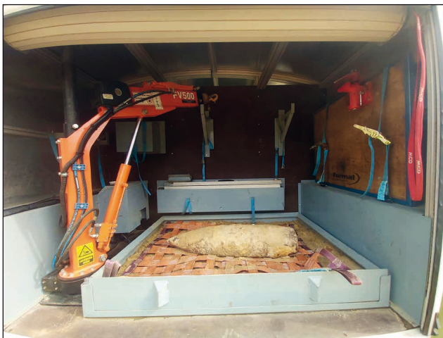
7. ábra. A budai Pusztaszeri úton 2022. szeptember 10-én előkerült, majd hatástalanított 203 mm-es kaliberű, szovjet gyártmányú, betonromboló típusú tüzérségi gránát szállításra előkészítve, egy MB U 4000 duplafülkés honvédségi járműben (Forrás: az MH 1. HTHE gyűjteményéből)
