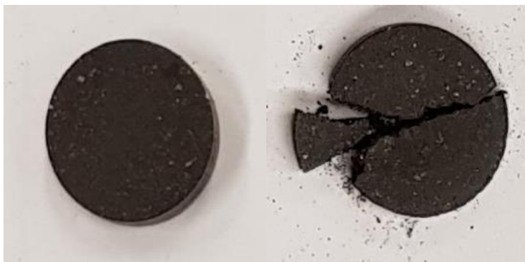
2. ábra: ATB mintaanyag a törési vizsgálat előtt (bal oldal) és után (jobb oldal)
