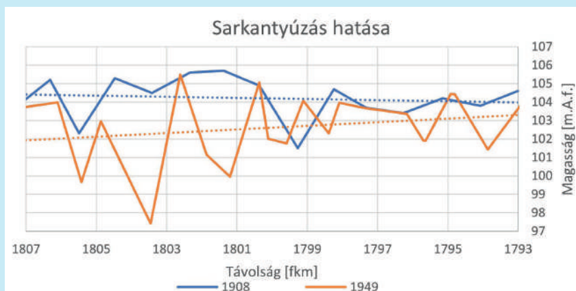
5. ábra: Sarkantyúk beépítésének hatása
