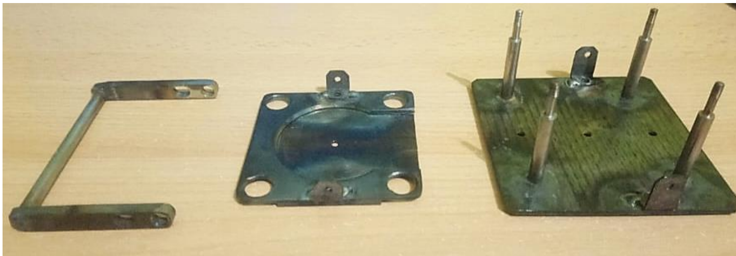
Emelőkar, mintatartó tálca és a vázsszerkezet hegesztés után
