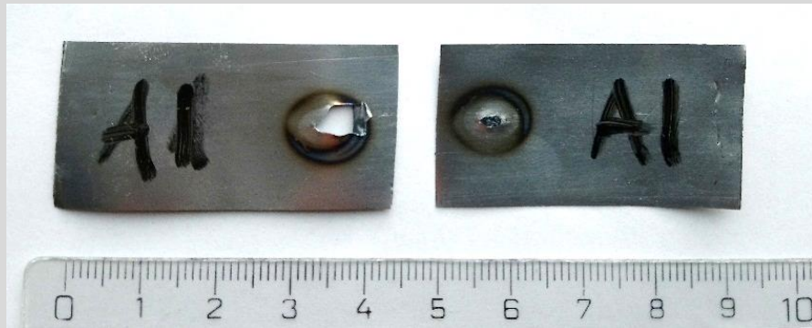
0,1 mm-es próbatest szakítás után
