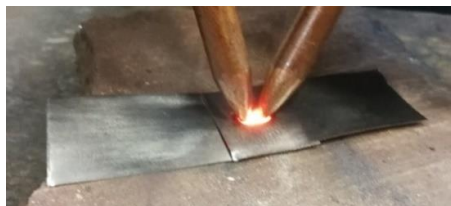
4. ábra. Próbatestek készítése nyíró-szakító vizsgálat számára
