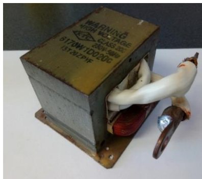
1. ábra. Új szekunder tekercssel ellátott, egy mikrohullámú sütőből kiserelt transzformátor
