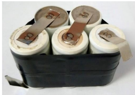
6. ábra. Az elkészített ponthegeesztő berendezéssel létrehozott Ni-Cd akkupakk
