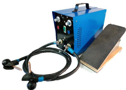
3. ábra. Az elkészült ponthegesztő a munkakábel-ekkel és elektródákkal, valamint a lábkapcsolóval
