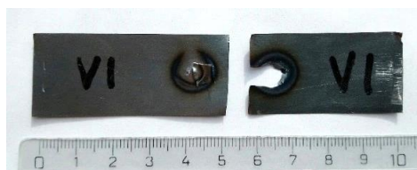
5. ábra. A kigombolódás jelensége egy 0,2 mm vastagságú lemezről készült próbatest esetén
