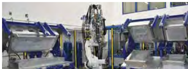
1. ábra A Topline technológiát kiegészítő ABB robot és Frimo formahordozók a jelenleg használt formákkal
