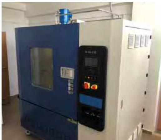
6. ábra GP-VOC-010D típusú VOC kamra
