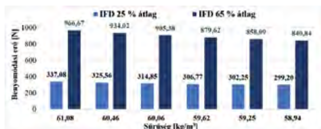
8. ábra A benyomódás (IFD) vizsgálatok eredményeinek átlaga az azonos tömegű mintákon az átlagos terméksűrűségek függvényében
