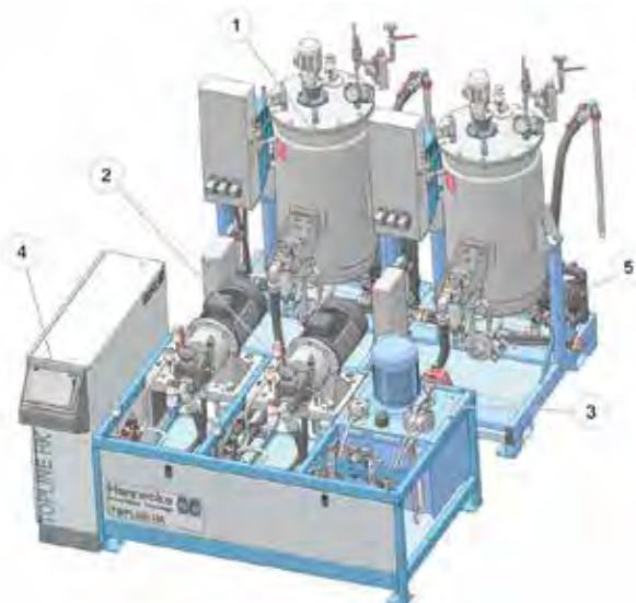
2. ábra Topline nagynyomású poliuretán gyártóberendezés elvi felépítése [1]
