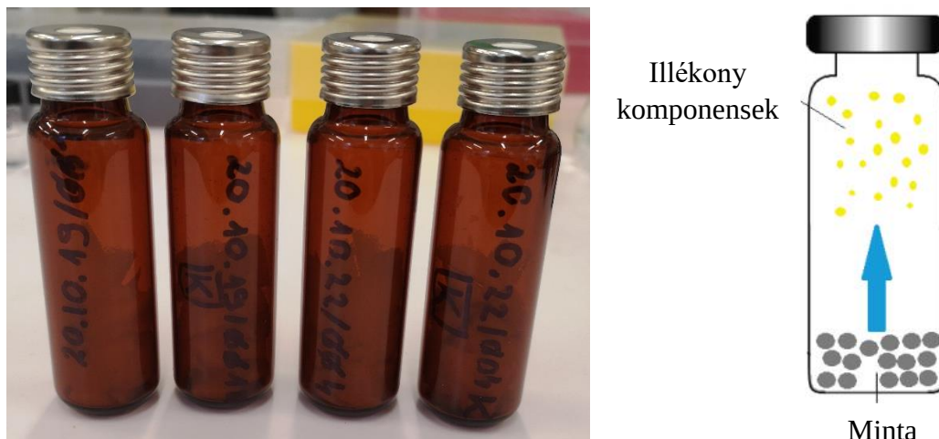
33. ábra: Az aprított minták a headspace fiolákban, valamint a termikus kezelés során bekövetkező emisszió sematikus ábrája [41].
