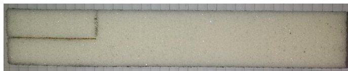
27. ábra: Az ASTM D 3574 szabvány TEST F leírása szerint kivágott minta.
