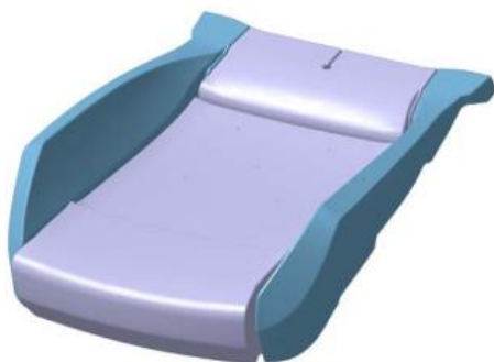
10. ábra: Kettős keménységgel rendelkező első ülés ülőlap CAD terve [10].
