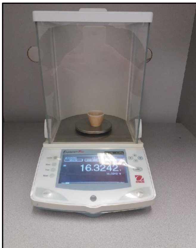
19. ábra Egy üres izzítótégely tömegének mérése négy tizedesjegyre az Ohaus EP213C Explorer Pro Precision Balance műszer segítségével (Forrás: Vári Tamás Zsolt)
