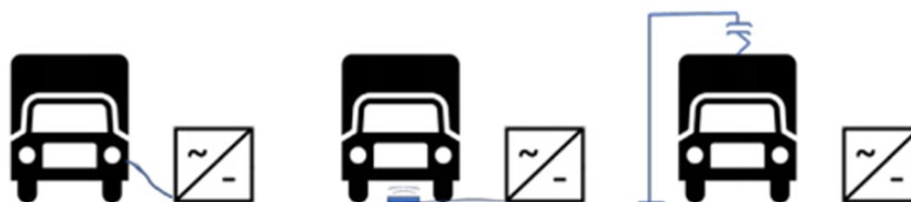
12. ábra: Elektromos nehéz tehergépjárművek töltési technológiái.
