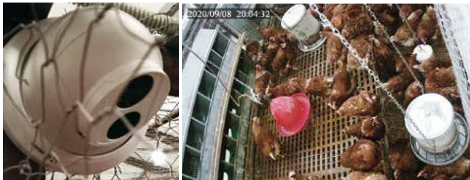
2. kép: A fülkébe felszerelt infravörös kamera HD minőségű felvételek rögzítésére alkalmas és a fülke belső elrendezése látható
