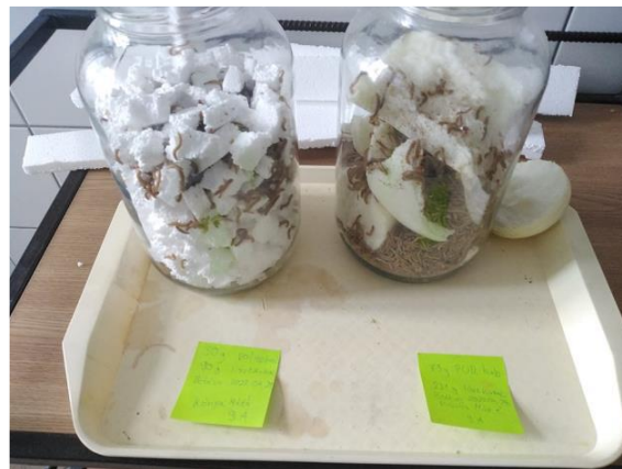
8. ábra Kísérleti elrendezés polisztirol és poliuretán lisztkeverékkel történő biodegradációjának vizsgálatához.
