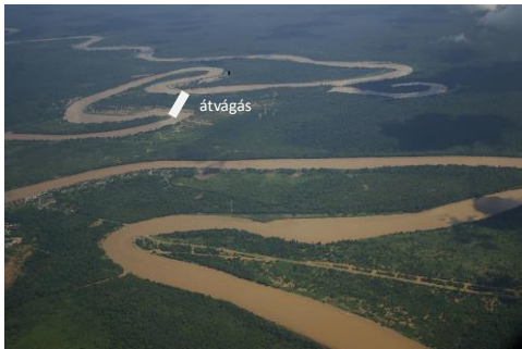
3. ábra Folyószabályozás a hurkok átvágásával
