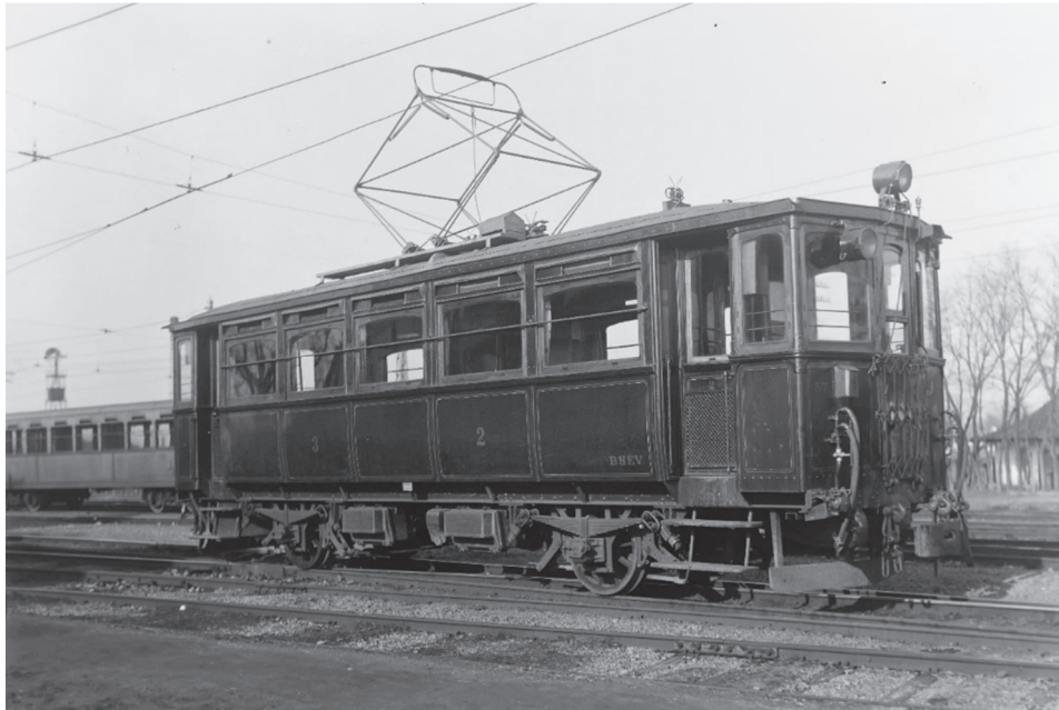
2. kép: A BHÉV MI típusú, M 57 pályaszámú távkapcsolású villamos motorkocsija Cinkota forgalmi telepen
