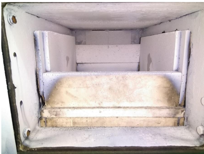
Obr. 2 Nánosy v prvním tahu kotle při spalování pelet ze slunečnice
