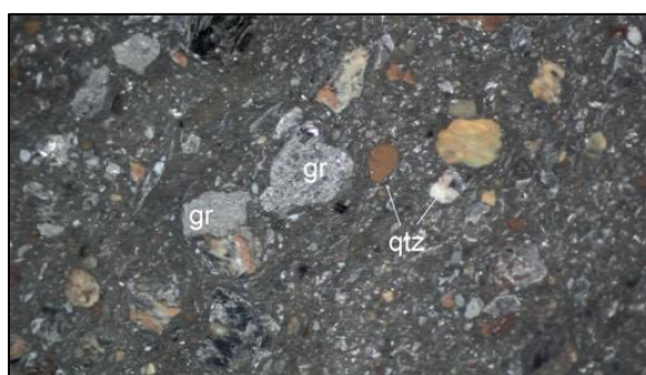
6. ábra: A Perkáta – Nyúli-dűlőről származó minta vékonycsiszolatának mikroszkópos felvételei. A baloldali két ábra polarizációs mikroszkóppal, míg a jobboldali sztereomikroszkóppal készült. gr: grafit, qtz: kvarc
