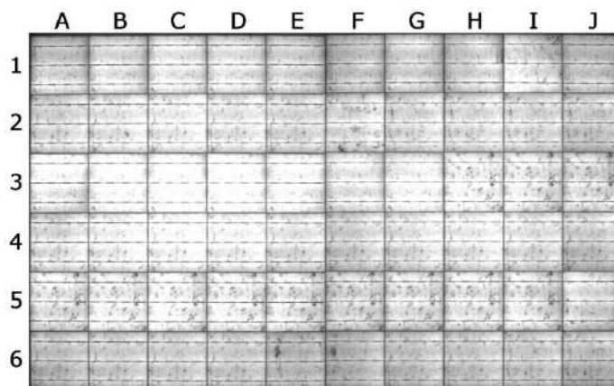
5. ábr.: Egy gyári állapotú napelempanel elektrolumineszcencia-felvétele
