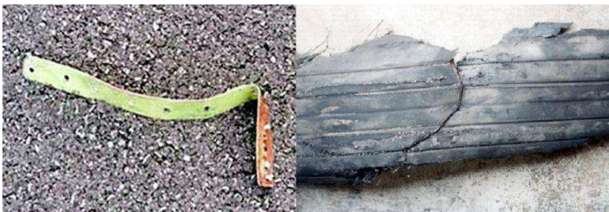
5. ábra. A katasztrófát okozó lemezdarab [12]
