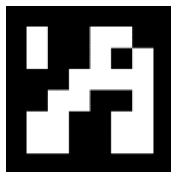
9. ábra. Példa az Aruco Markerre [19]
