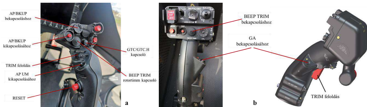
4. ábra. H145M a) forgószárnylapátok ciklikus beállítási szög-vezérlő kar ; b) egyesített vezérlő kar (EVK). Szerkesztette és készítette: a szerzők a [9], [10] irodalom alapján
