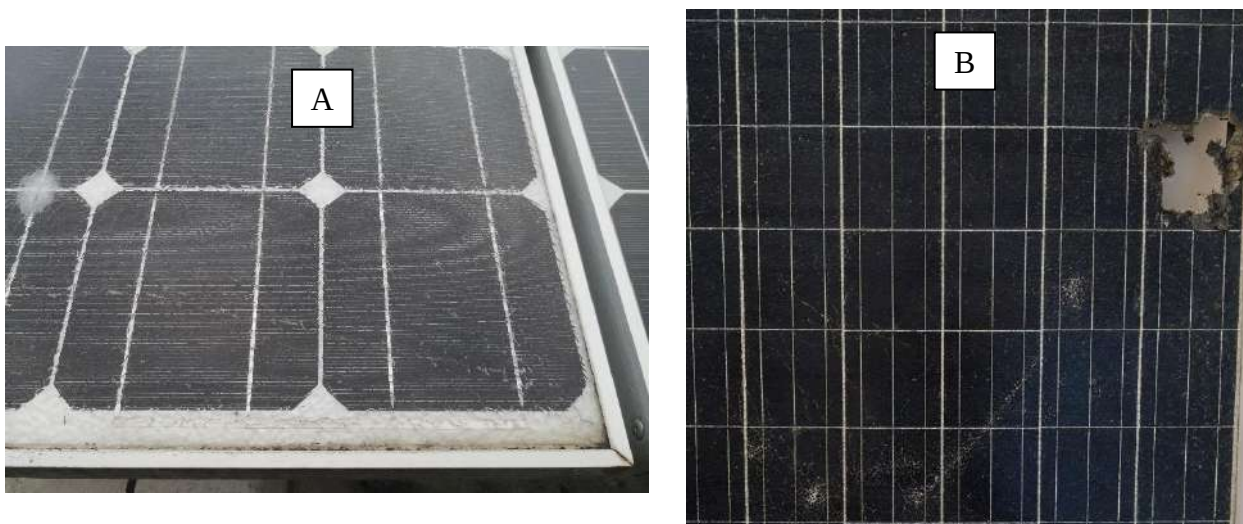
2. ábra. Jégverés (A) és villámcsapás (B) okozta repedések
