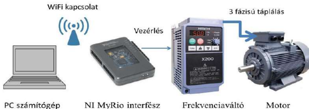
6. ábra. Távoli motorvezérlés MyRIO-val (forrás: saját ábra)
