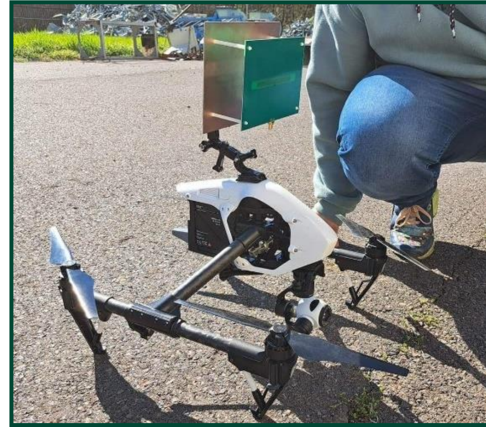
UAV „L” band antenna on top
