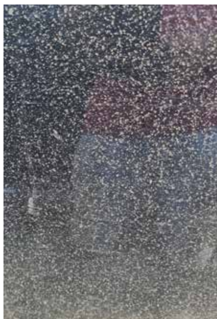
5. kép A DJI Agras T30-as permeteződrónjának szórásképe
