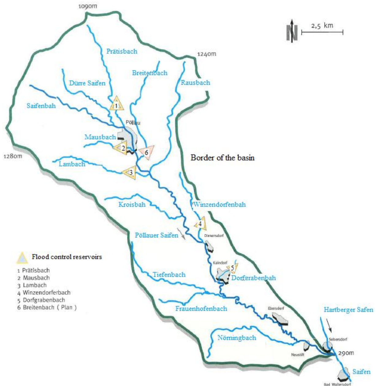
Figure 13 Flood control reservoirs (Source: Amt der Steiermärkischen Landesregierung 1999)
