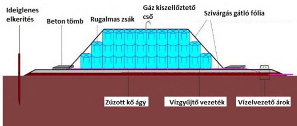
6-25. ábra: Az ideiglenes tárolók felépítése [6.5]
