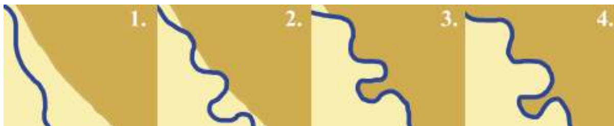
2. ábra: A Rima kanyarulatképződésének és –vándorlásának, a terasz pusztulásának folyamatábrája. A sötét szín a teraszt, míg a világos az alacsonyabb fekvő árteret jelöli.
